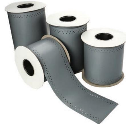
Hydroflex TPE Dilatasyon Bandı, dilatasyon boşluklarının, ısıl genleşme derzlerinin ve çatlakların yalıtımında kullanılan yüksek elastikiyete sahip dilatasyon bandıdır. Delikli ve deliksiz olarak 150mm, 200mm, 250mm, 300mm, 400mm genişliklerde 1mm ve 1,50mm kalınlıklarda üretilmektedir.
